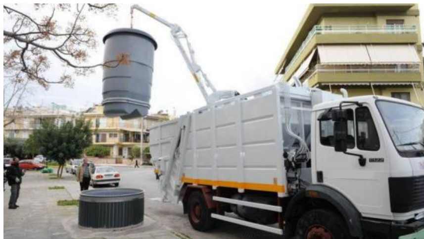
Εικόνα 18: Απορριμματοφόρο όχημα με γερανό (ενδεικτική εικόνα)
