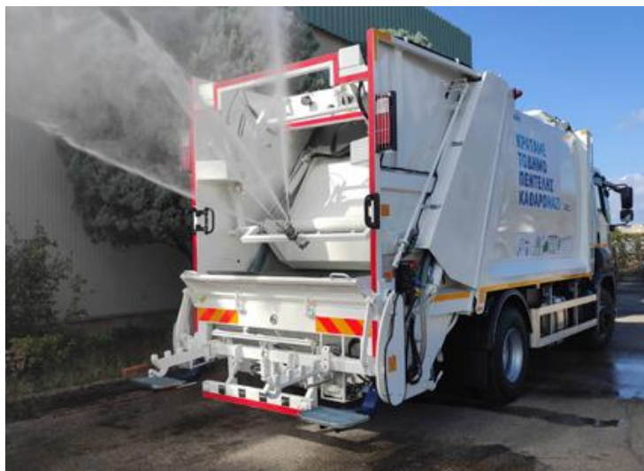
Εικόνα 19: Απορριμματοφόρο όχημα με σύστημα πλύσης κάδων (ενδεικτική εικόνα)
